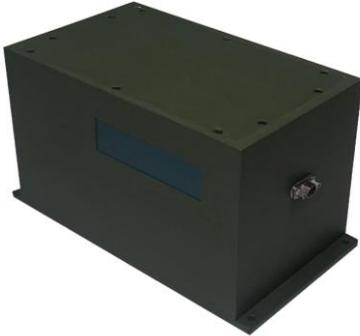
RTF100 型寻北仪主要用于快速自主确定真北方向。它由单自由度光纤陀螺、三轴加速度计、机械转动装置和信号结算电路构成。采用四点寻北法，借助两轴向的加速度计测量值，解算出产品基准线与北向的夹角，以及俯仰角和横滚角。可对产品的平台进行调校且不受外界磁场或其它环境的干扰和影响，具有寻北精度高和使用简单的特性。
